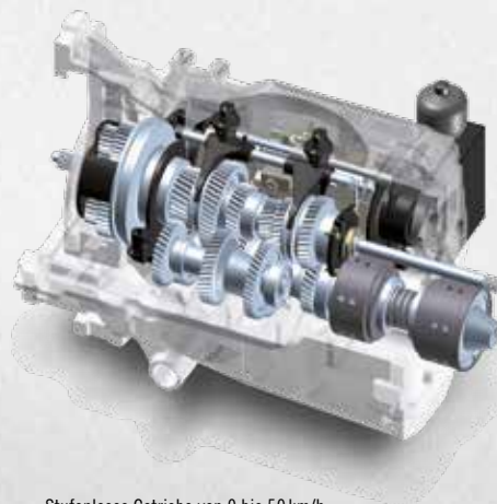
Stufenloses Getriebe von 0 bis 50 km/h
