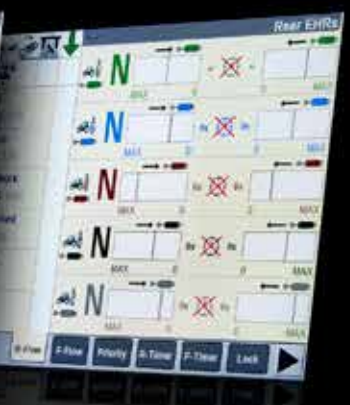
Durchflussmengen und Zeitsteuerung bestimmen
