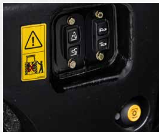
Leicht erreichbar: Die Außenbetätigung für Fronthubwerk, Frontzapfwelle und Steuergerät vorne.
