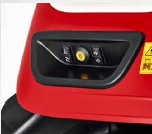
Außenbetätigung für Heckzapfwelle, Heckhubwerk und ein Steuergerät an beiden Heckkotflügeln.
