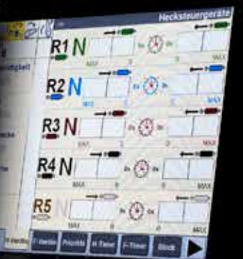
Durchflussmengen und Zeitsteuerung bestimmen
