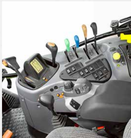
Profi Classic ausgestattet mit mechanischen Steuergeräten und elektr. Hubwerksregelung (EHR).
