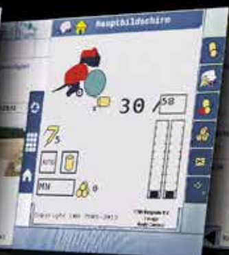
Anbaugeräte steuern und mit Videokameras überwachen
