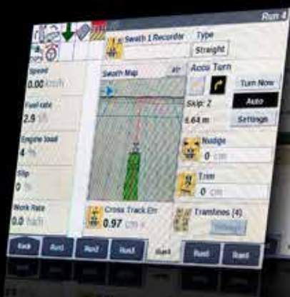
S-Turn II wendet automatisch am Ende der Fahrspur
