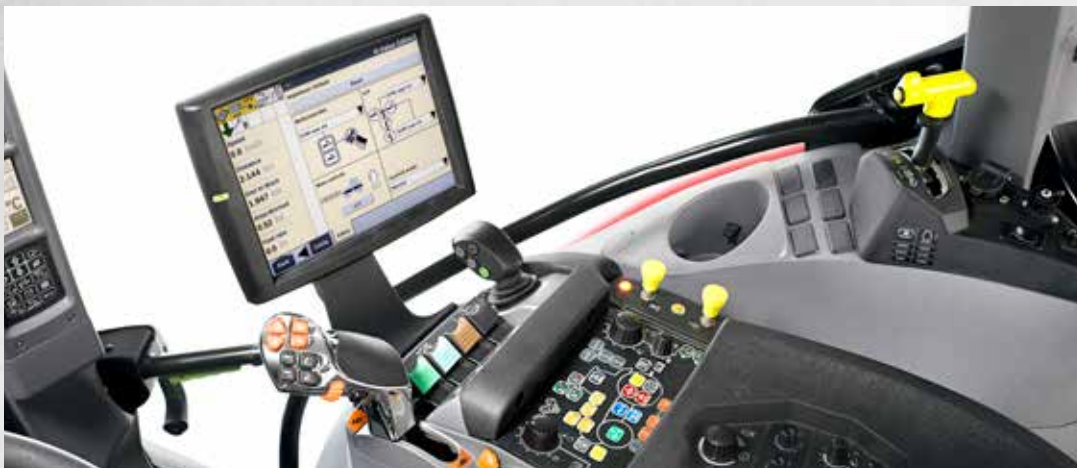
Profi und Profi CVT sind mit bis zu vier elektrischen Steuergeräten ausgerüstet.
