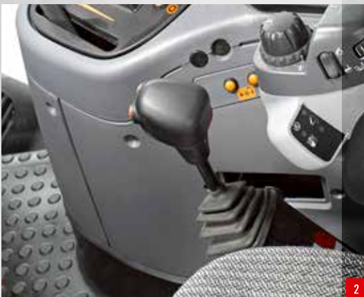
1 Joystick für Frontladerarbeiten bei Profi und Profi CVT
